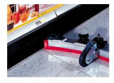
Sistema de arrastre de agua sucia por medio de squeegee con hules de uso industrial, permite contener hasta un 90% del agua utilizada.
