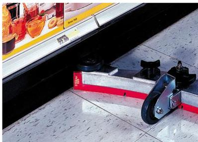
**Sistema de arrastre de agua sucia por medio de squeegee con hules de uso industrial, permite contener hasta un 90% del agua utilizada.**
