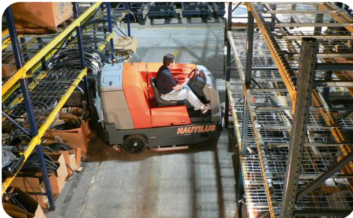
La barredora-fregadora Nautilus es un equipo con todos los adelantos para los trabajos extremos en todos los aspectos, alto nivel de eficiencia y maniobrabilidad, diseño robusto, esta máquina dual proporciona un alto rendimiento para su uso en grandes extensiones, con rendimientos de hasta 15,200 m<sup>2</sup>/h, su gran capacidad permite tiempos de operación largos, 120 minutos con un flujo de agua estándar y 70 minutos con un flujo de agua alto.
