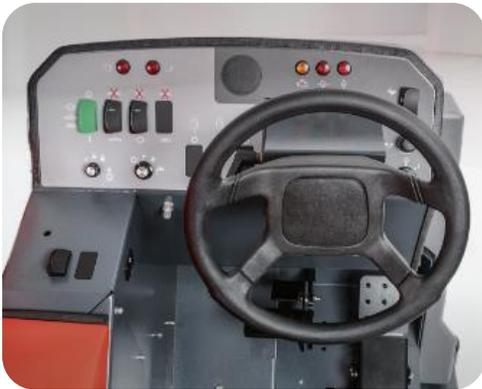
Sistema operativo de un botón: todas las funciones se pueden iniciar y detener con solo presionar un botón.
