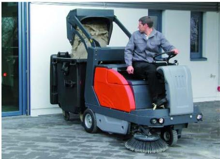
Gran sistema de recolección con deposito descargable hidráulico. Sistema automatizado para mayor producción.
